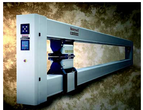
Figura 8 – Sistema de medida de gramatura “on-line”. Da Vinci™ Precision Platform 4000 da Honeywell
