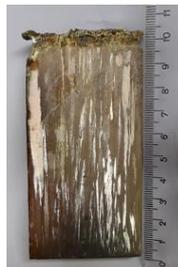
Fig. 8 - Macrografia do corpo de prova.
