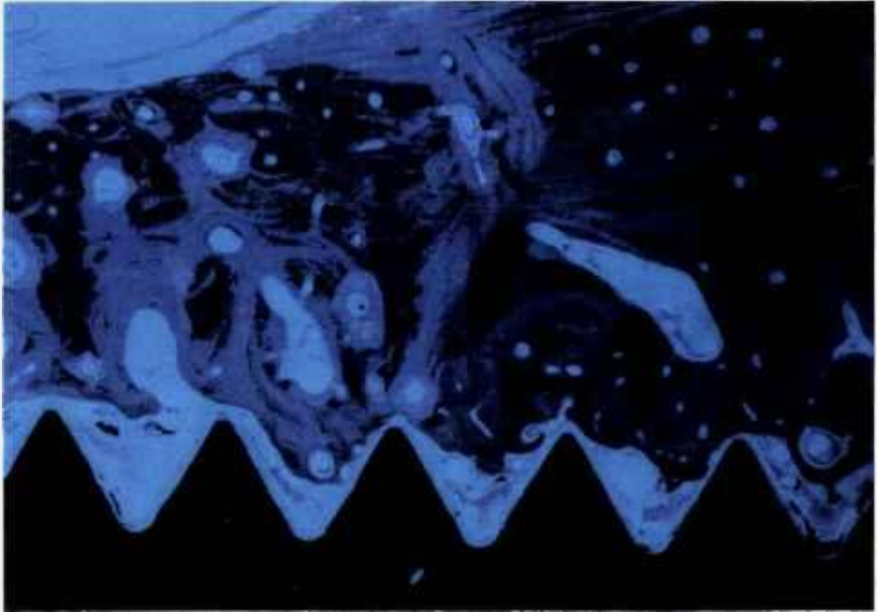
Figura 4.5.5 - Microscopia Óptica de alvéolo criado para implante com técnica de ultravioleta. Crescimento e ancoragem de fibroblastos na região dos passos do implante de Ti-6Al-7Nb. Aumento: 126X
