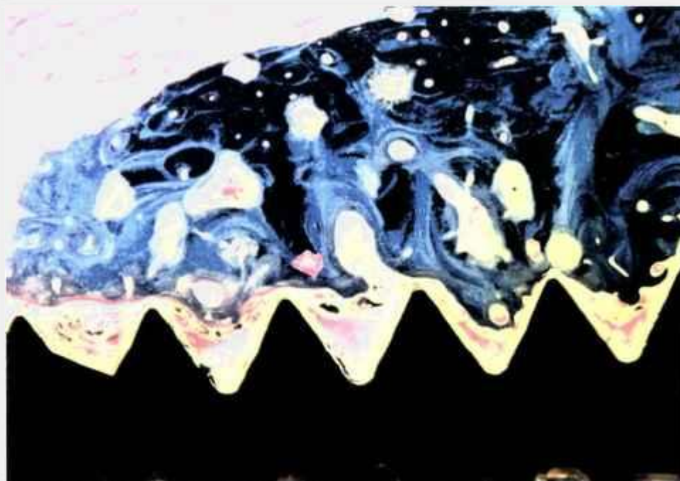
Figura 4.5.2 - Microscopia Óptica de corte histológico de implante Ti-6Al-7Nb, mostrando as etapas ocorridas com as suas cores. Rosa colágenos; azul-claro início da calcificação; azul-escuro osso calcificado e preto implante. Aumento: 126X
