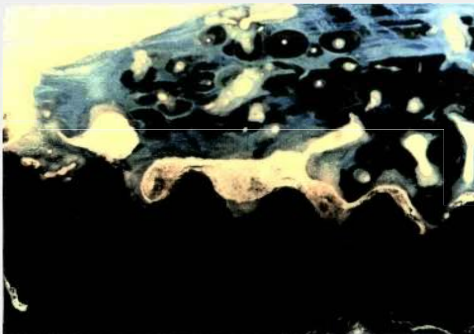
Figura 4.5.8- Microscopia Óptica de corte histológico de implante Ti-6Al-7Nb revestido por hidroxiapatita, mostrando o processo de crescimento ósseo em direção ao implante. Aumento: 126X
