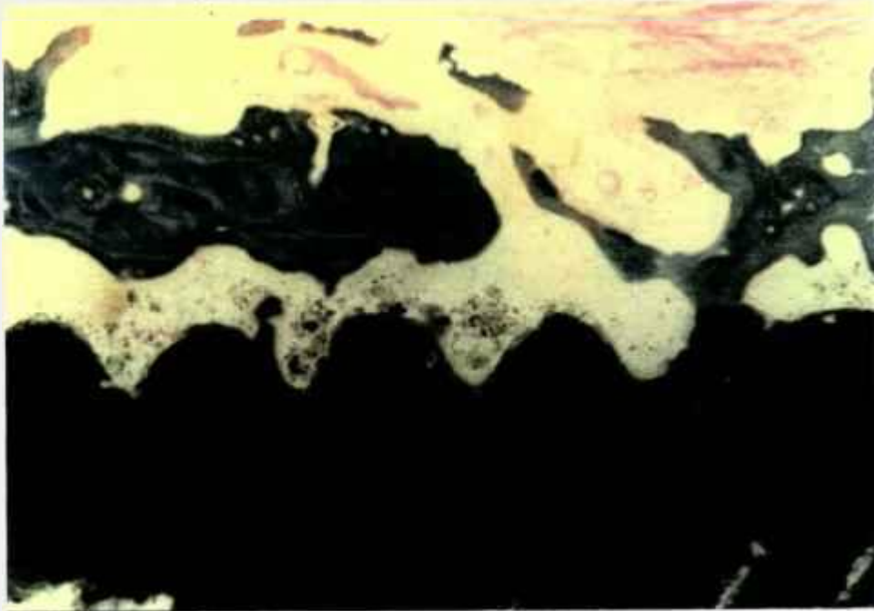
Figura 4.5.7 - Microscopia Óptica de corte histológico de implante Ti-6Al-7Nb revestido por hidroxiapatita, mostrando o processo de crescimento ósseo em direção ao implante. Aumento: 126X
