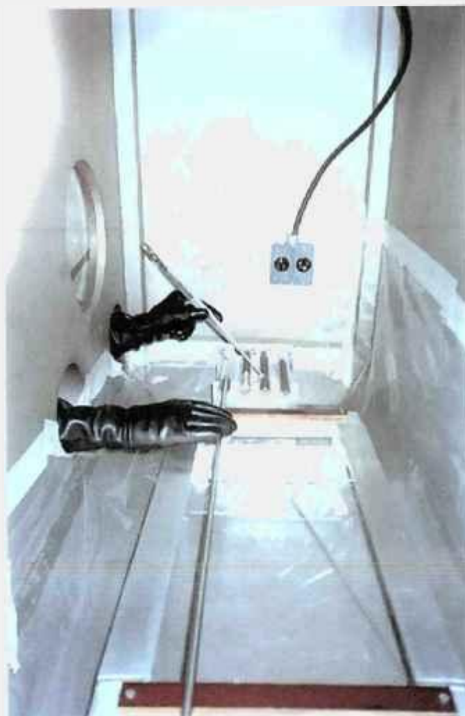
Figura 2.8 Montagem no Interior de Capela do Conjunto Folhas “catcher” e Folha de Urânio na Vareta Combustível Especial para Posterior Irradiação no Núcleo do Reator IPEN/MB-01.
