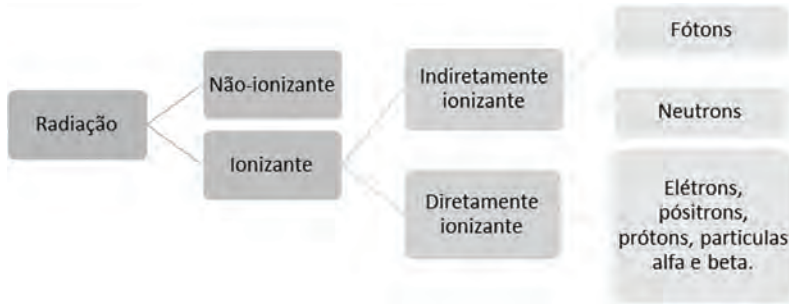
Figura 2 - Classificação da radiação em relação ao poder de ionização e às formas de ionização
