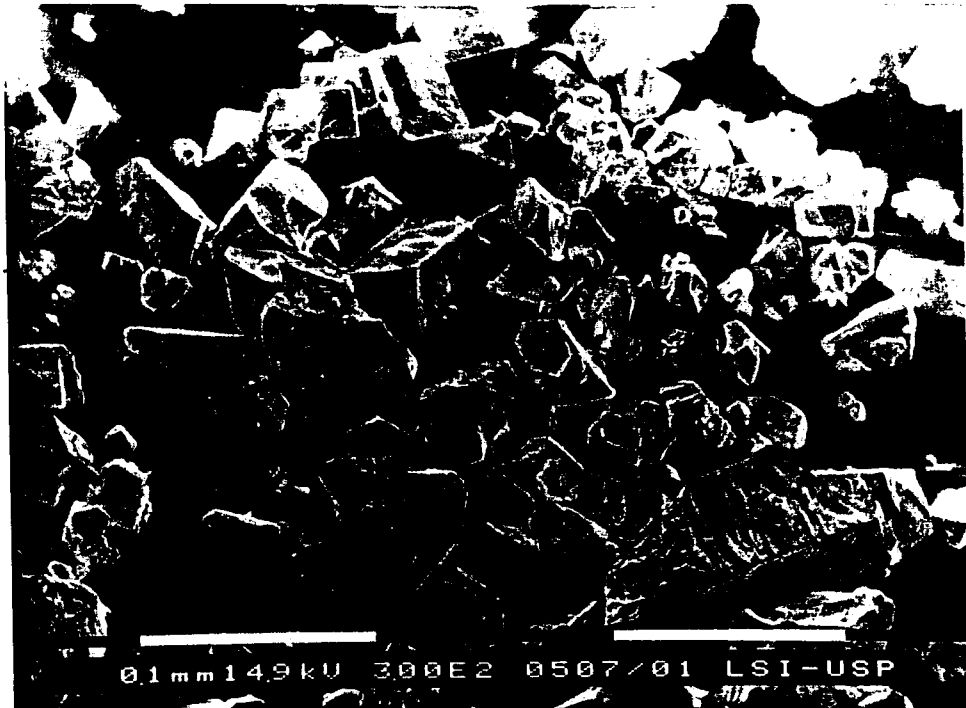
Figura 4.9 - M.E.V. U_3O_8 de TCAU calcinado 800^{\circ}C-3h (não classificado).
