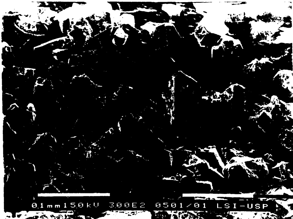
Figura 4.8 - M.E.V. U_3O_8 de TCAU calcinado 700^{\circ}C-3h (não classificado).
