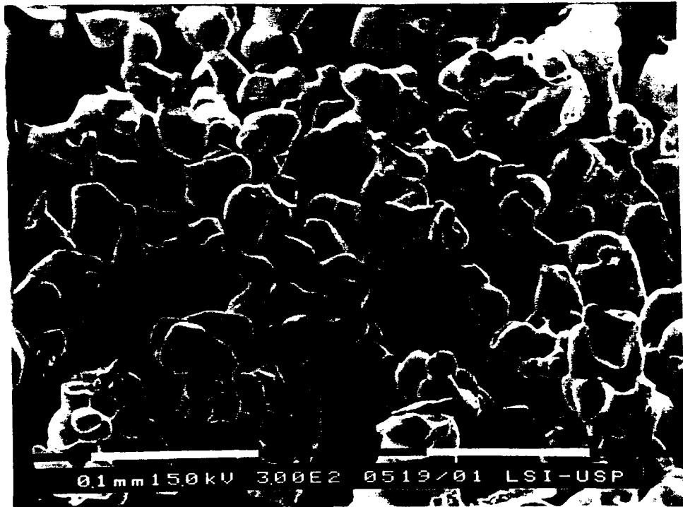
Figura 4.10 - M.E.V. U_3O_8 de TCAU calcinado 600^{\circ}C -3h, sinterizado 1400^{\circ}C -6h (não classificado).
