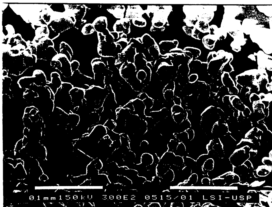
Figura 4.14 - M.E.V. U_3O_8 de TCAU calcinado 600^\circ\text{C} -3h, sinterizado 1400^\circ\text{C} -24h.
