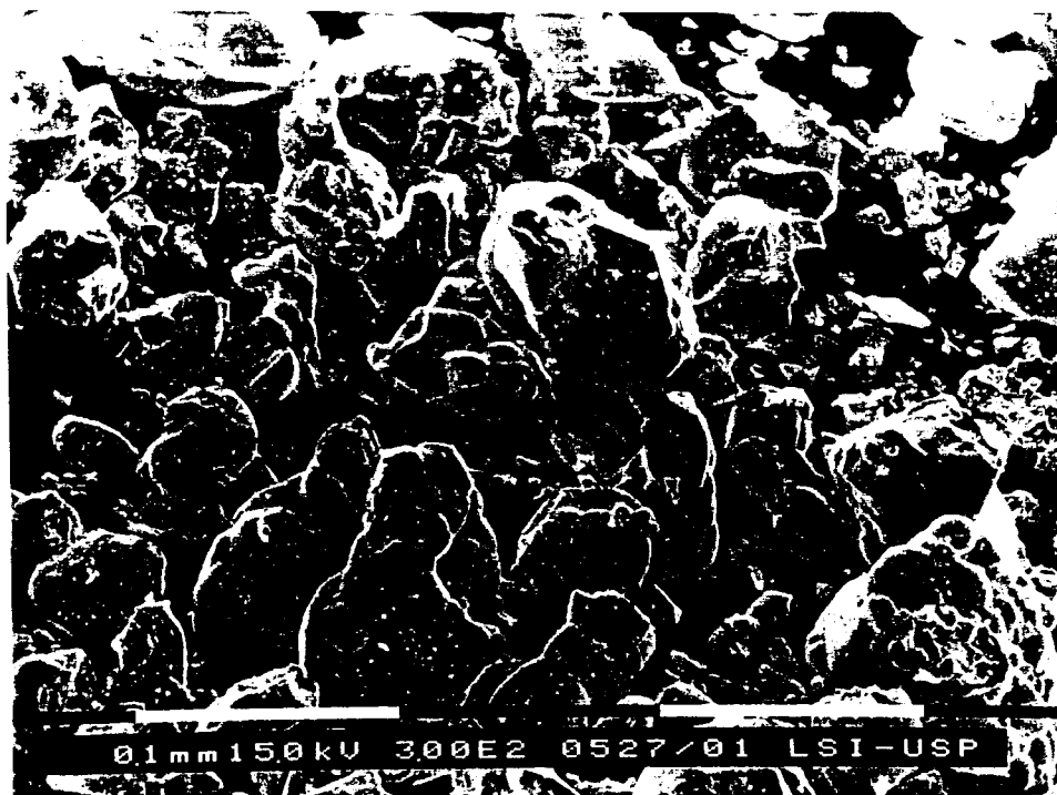
Figura 4.13 - M.E.V. U_3O_8 de DUA calcinado 600°C-3h, sinterizado 1400°C-24h (não classificado).
