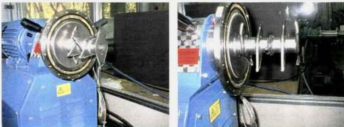
Figura 5.13: Estado das hastes após a realização da primeira série de moagens, mostrando o arrancamento dos insertos de metal duro.
