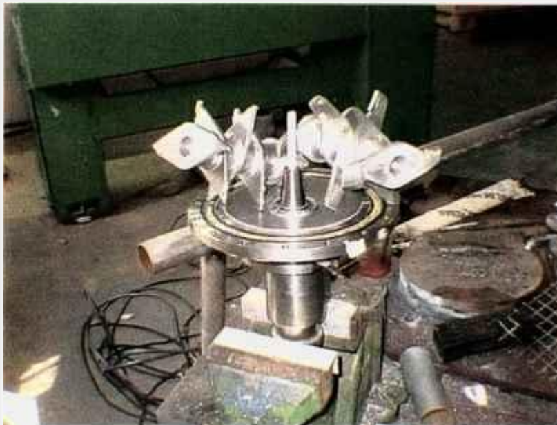
Figura 5.14: Detalhes do rotor do moinho, comparando uma haste nova e uma usada.
