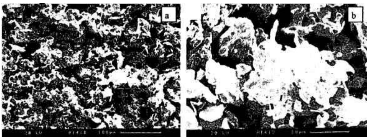
Figura 5.23: Ensaio AH5, após 6 horas de moagem.
