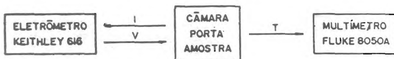
Fig. II.1: Diagrama de blocos simplificado do sistema de medidas de resistividade elétrica em materiais cerâmicos.
