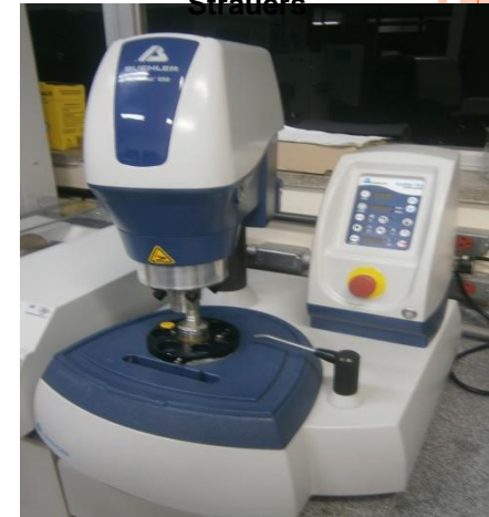
Passo 8: Polimento das amostras será feito na politriz com diferentes discos de lixa de gramatura
