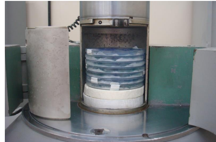
Posicionamento das placas de Petri para serem submetidas a irradiação gama
