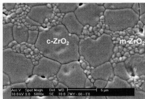
Figura V.5.3.1- Micrografia obtida por MEV da superfície polida e submetida ao ataque térmico, da amostra ZMY-00 sinterizada a 1500 °C por 1h, indicando os grãos de c-ZrO_2 e m-ZrO_2 .
