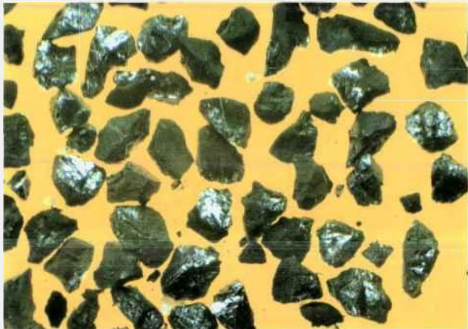
Si-GM -4+14 malhas Tyler - Microscópio estereoscópico - (Aumento 8 X)
