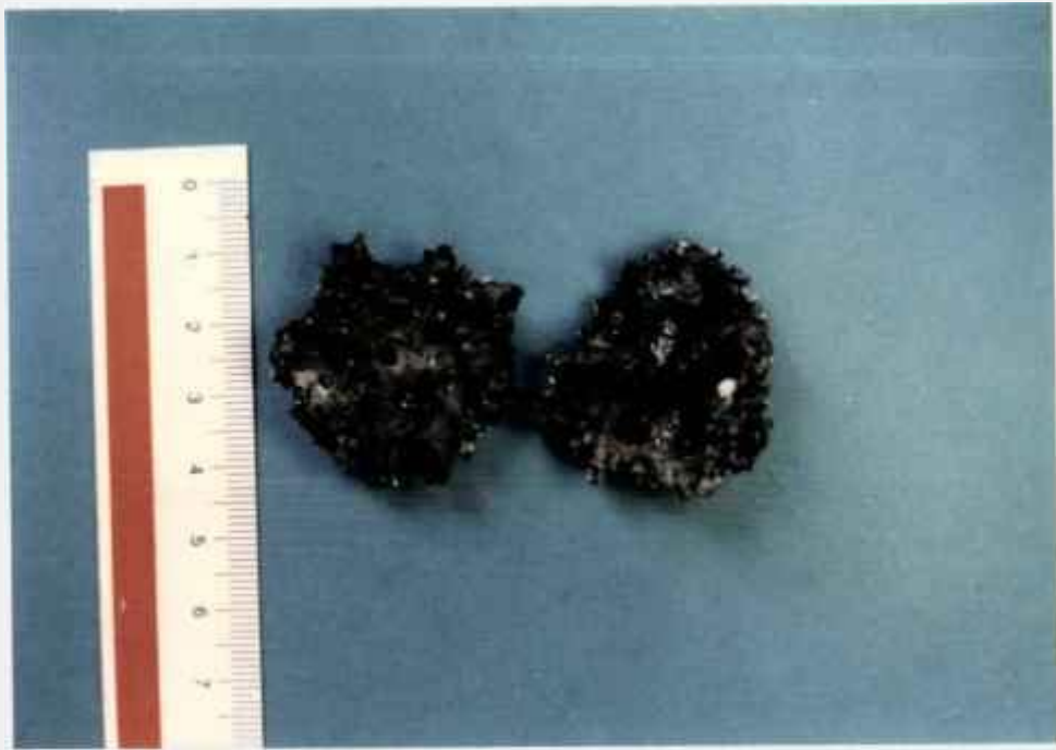
Figura 5.5 - Aglomerado de partículas de Si com granulometria abaixo de 200 malhas
