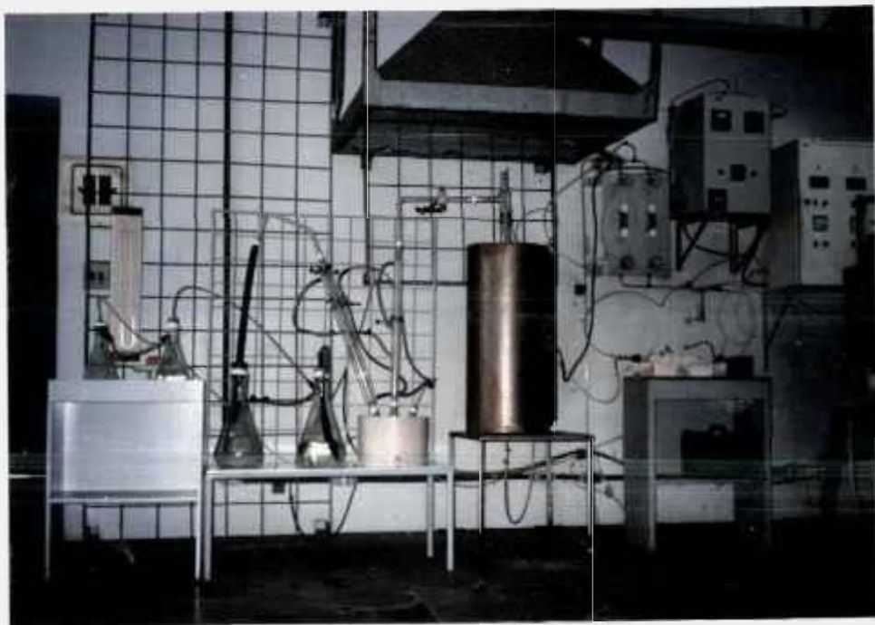
Figura 4.2 - Vista geral do arranjo experimental da unidade de cloração Si-GM.
