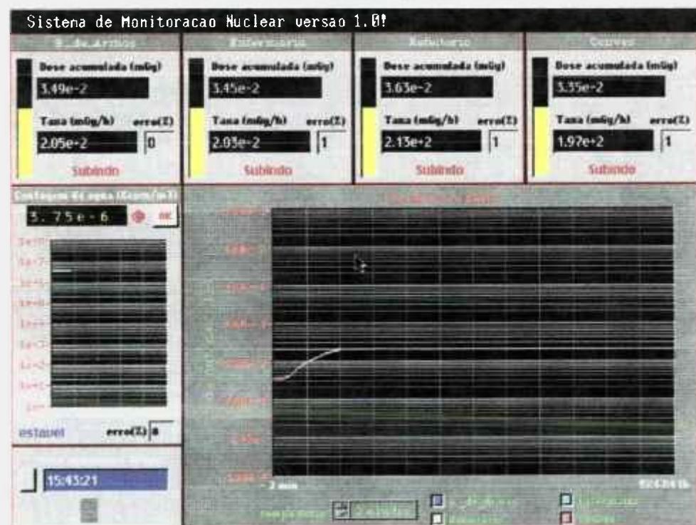
Figura 4.3.1 - Foto da Tela Principal com o Nível de Contagens Normal, Estáveis e com o Sistema de Monitoração de Água não Contando.
