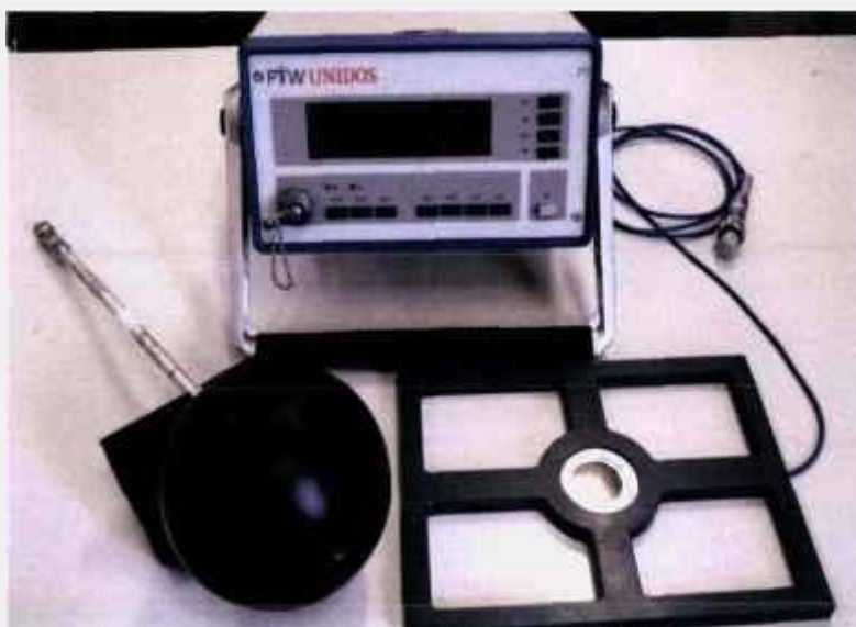
Figura 3.1. Sistema dosimétrico composto por um eletrômetro PTW UNIDOS e uma câmara de ionização esférica de 1,0 litro (PTW 32002-A) e outra câmara de ionização de placas paralelas de 1,0 \text{cm}^3 (PTW 77334).
