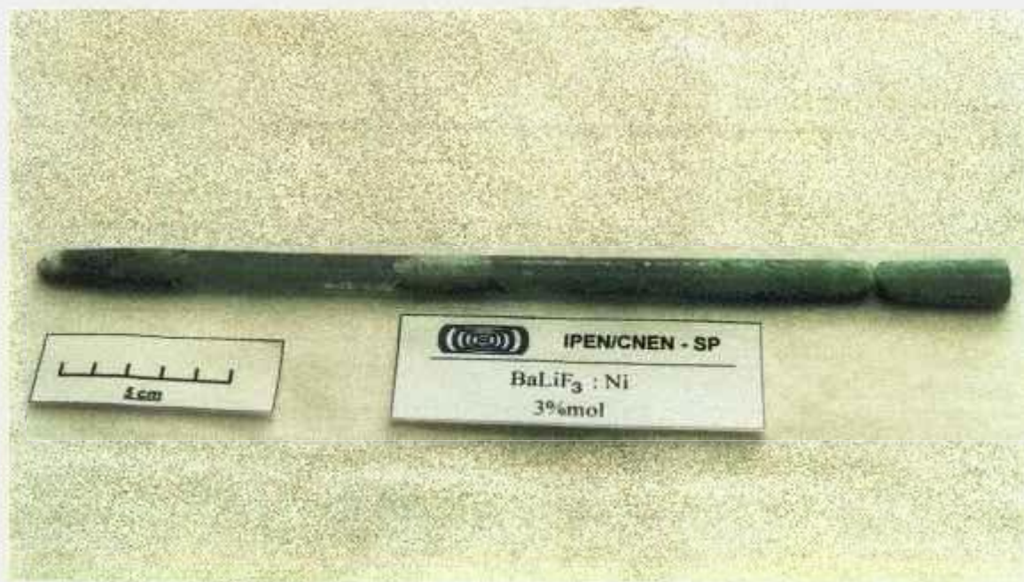
Figura 4.13 - Fotografia do lingote de BLF:Ni 2+ refinado com concentração inicial de 3 mol% de Ni 2+ .
