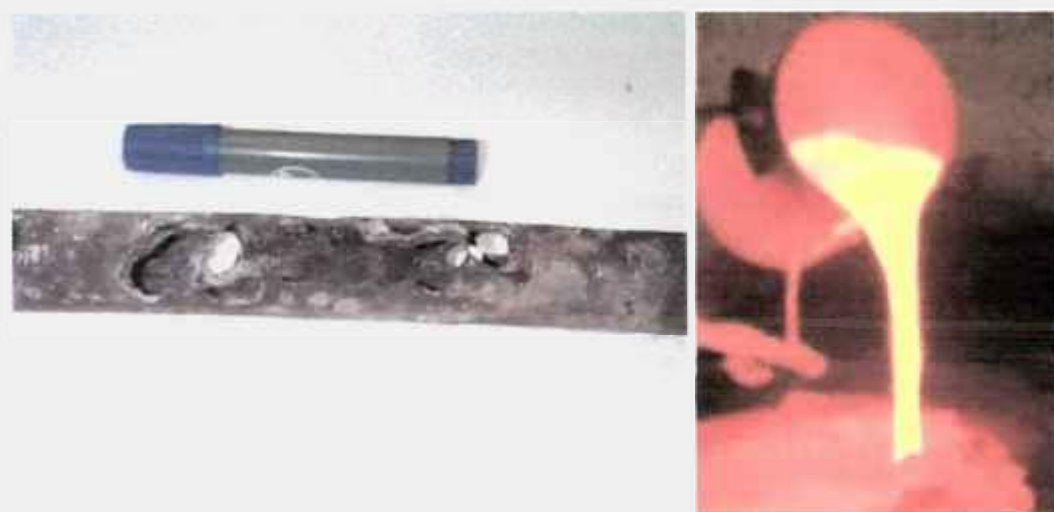
Figura 4.4 - Corrosão observada em lança constituída de tubo de aço inoxidável AISI 304 e carbonato de sódio em fusão.
