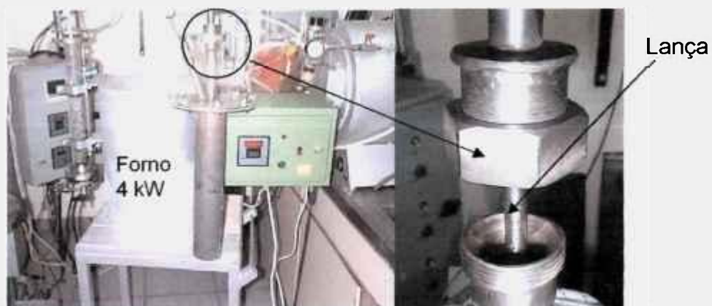
Figura 4.41 - Vaso do reator e sistema de aquecimento com potência de 4kW (esq.), lança e acoplamento (dir.).
