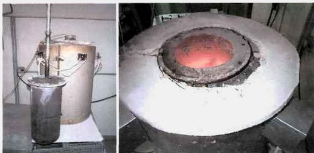
Figura 4.3 - Sistema de aquecimento e reator (esquerda) e reator aberto, com sal a cerca de 1000°C (direita).
