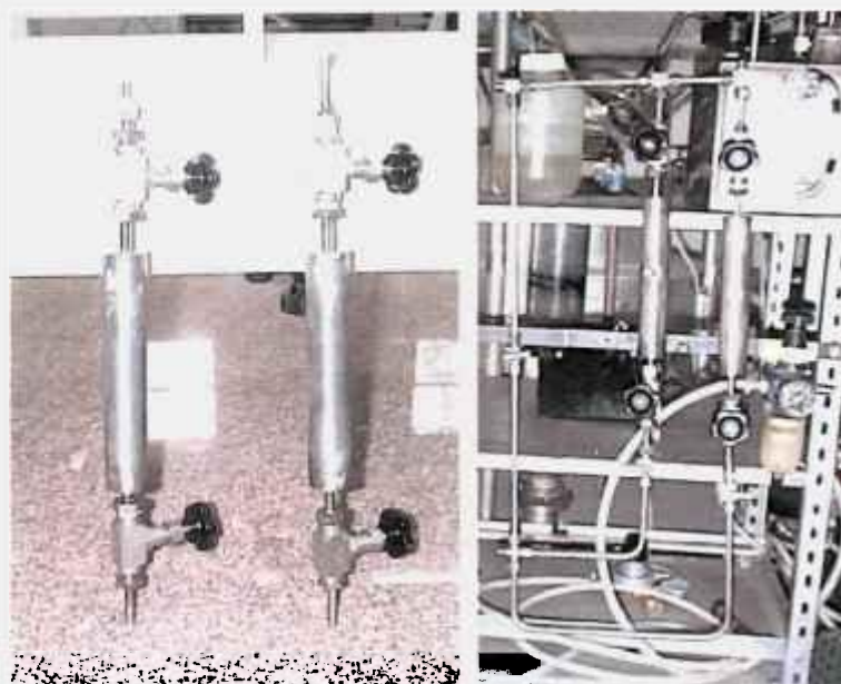
Figura 4.26 - Ampolas de aço para coleta de amostra de gases (esq.) e montagem na derivação da linha de gases (dir.).
