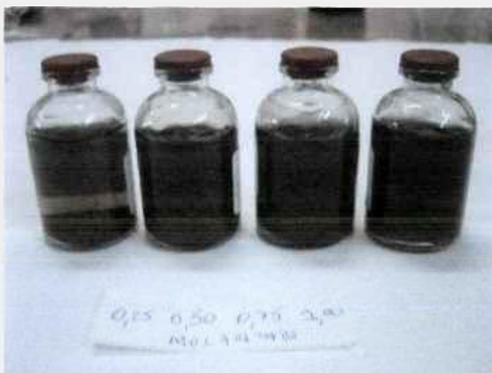
Figura 5.48 - Suspensões resultantes da mistura da solução aquosa de mercúrio com soluções com diferentes concentrações de tiouréia e pH 11.
