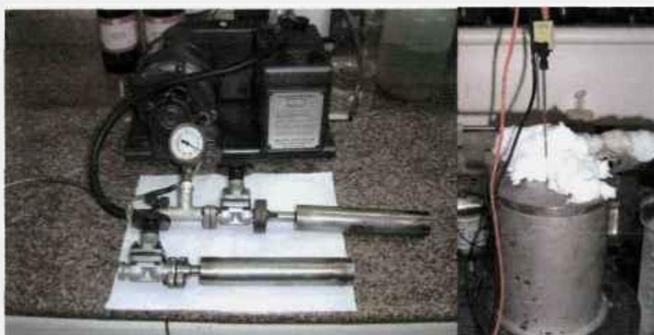
Figura 4.35 - Ampolas para coleta de amostras e bomba de vácuo (esq.); forno resistivo para limpeza das ampolas (dir.).
