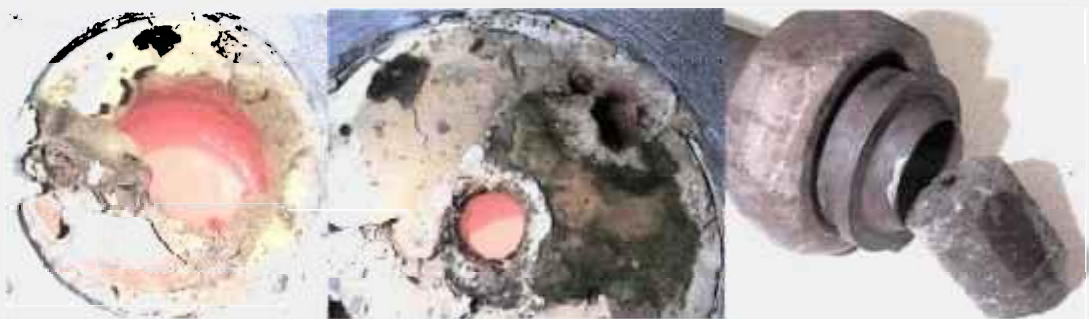
Figura 4.5 - Oclusões do reator na região do flange (esq. e centro) e "plug" de sal solidificado(dir.), provocado por arraste de sal no duto de exaustão.
