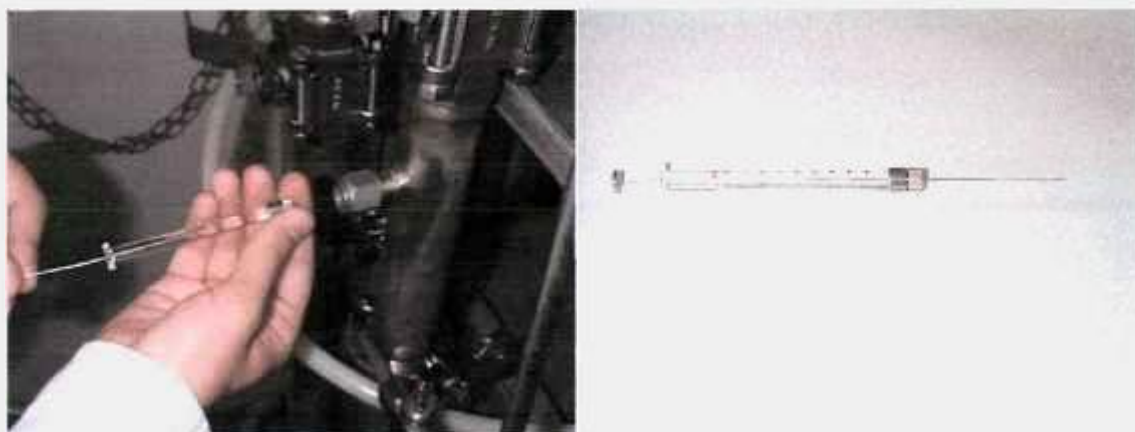
Figura 4.27 - Retirada de amostra de gases por meio do septo na linha de exaustão (esquerda) e respectiva seringa.
