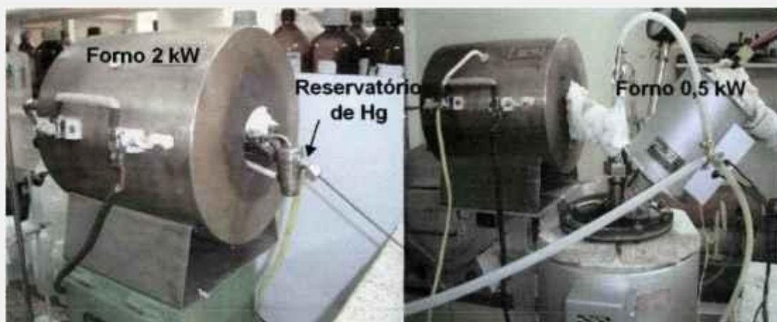
Figura 4.42 - Sistema de pré-aquecimento do ar e reservatório de Hg (esq.), aquecimento dos gases para evitar condensação (dir.).
