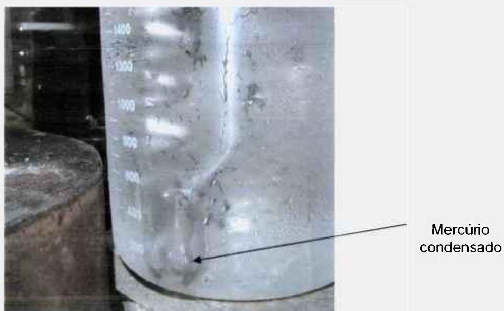
Figura 5.53- Mercúrio condensado a partir dos gases da exaustão, após passagem pelo banho salino.
