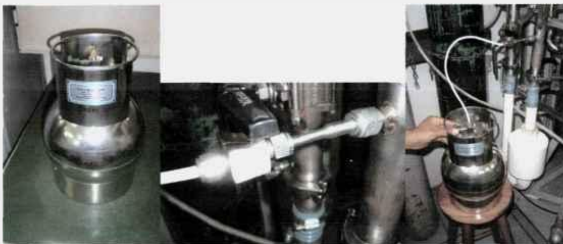
Figura 4.34 - Balão de aço (esq.), derivação da linha e válvula (centro) e retirada de amostra (dir).
