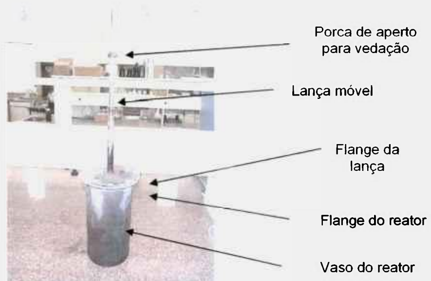
Figura 4.2 - Vaso do reator e lança para introdução do resíduo.
