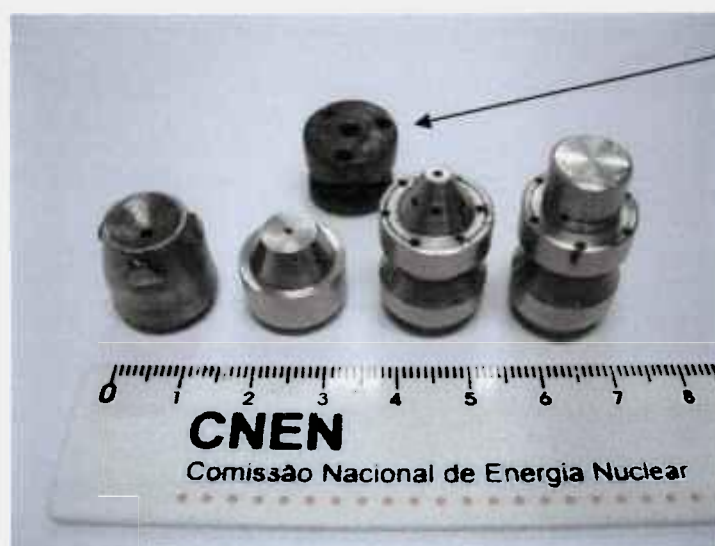
Figura 4.23 - Diferentes concepções desenvolvidas de bicos aspersores.
