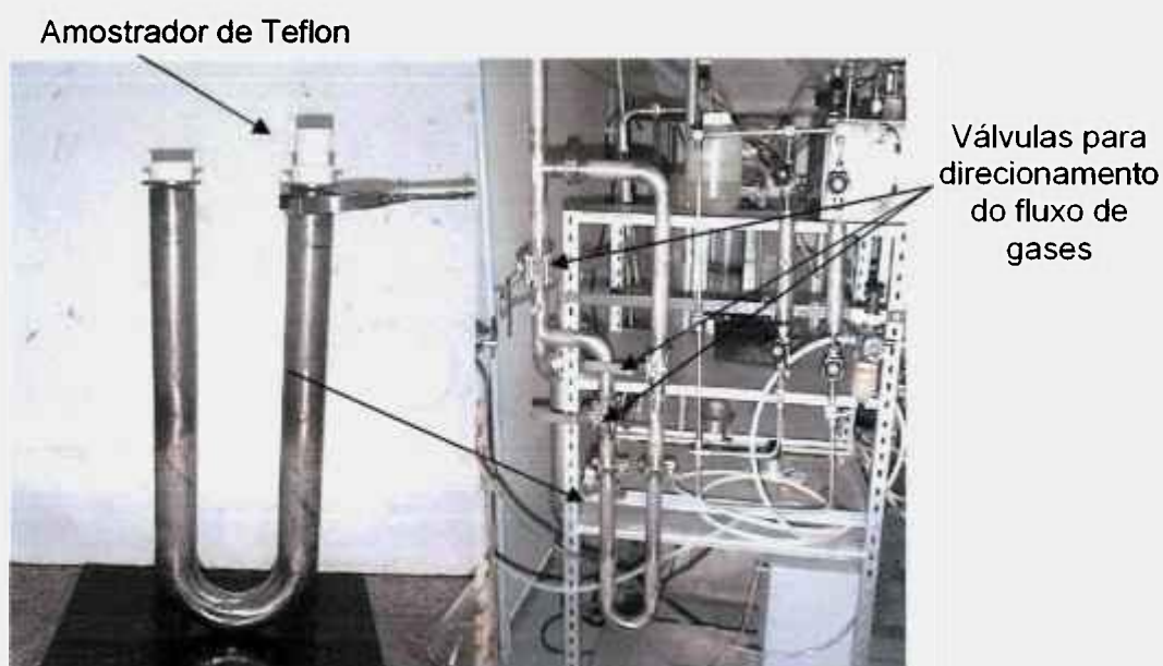
Figura 4.33 - "U" removível, onde são colocados os amostradores (esq.); válvulas e "by-pass" para direcionar os gases para o amostrador (direita).
