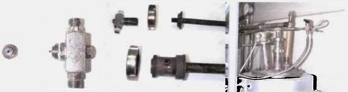
Figura 4.11- Bico nebulizador, anéis para acoplamento e lanças interna e externa (esq.), lanças montadas no reator (direita).
