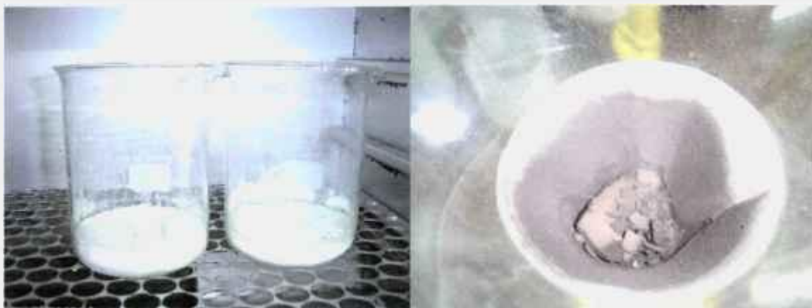
Figura 5.49 - Sal recuperado após dissolução, filtração e precipitação a partir do filtrado (esq.) e material retido no filtro, principalmente na forma de óxidos metálicos (direita).
