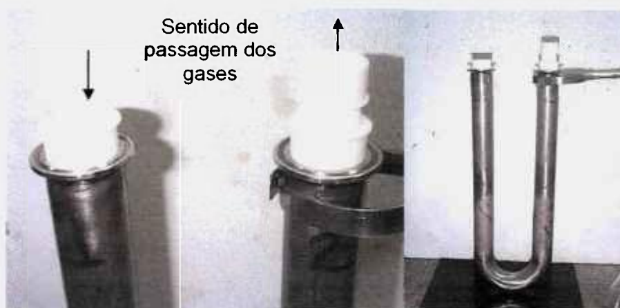
Figura 4.32 - Posicionamento dos amostradores de Teflon® (esq.), na entrada e saída do "U" do sistema de amostragem (dir.).
