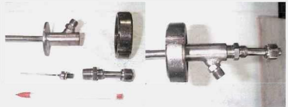
Figura 4.12 - Lança interna, anel de acoplamento, agulha injetora e conexão com a linha de alimentação do resíduo (esq.); montagem da lança (dir.).
