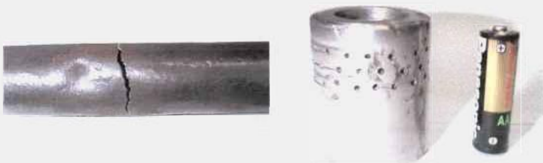
Figura 5.1 – Lança danificada e bocal com furos circunferenciais.
