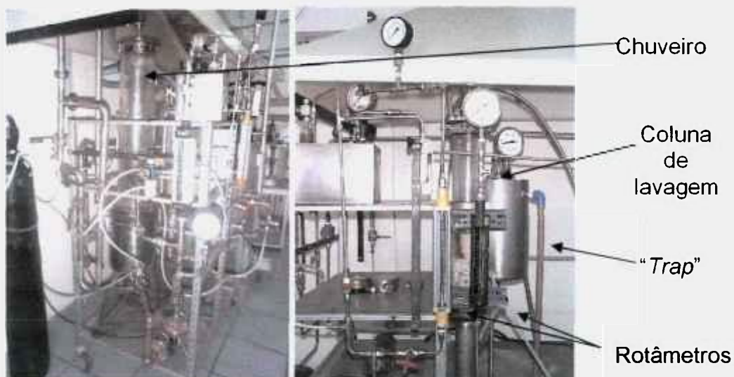
Figura 4.37 - Chuveiro para lavagem de gases (esq.); "trap" de H 2 O e sal, coluna de lavagem e rotômetros para controle da vazão de ar e O 2 (dir.).
