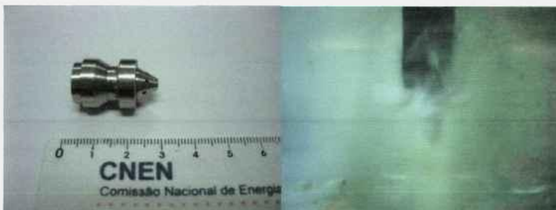
Figura 5.24 – Bico aspersor cônico (à esquerda) e padrão de bolhas formado (dir).
