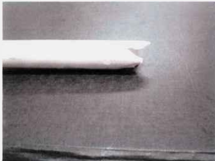
Figura 4.9 - Fratura de tubo de alumina cristalizada, utilizado como lança de injeção.
