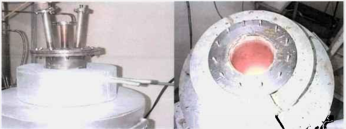
Figura 4.8 - Vista do reator montado no sistema de aquecimento e reator aberto contendo carbonato de sódio fundido a cerca de 1000°C.
