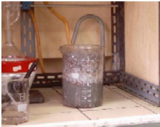
Figura 9 – Reação NaOH 2 M sem agitação com formação de gases.
