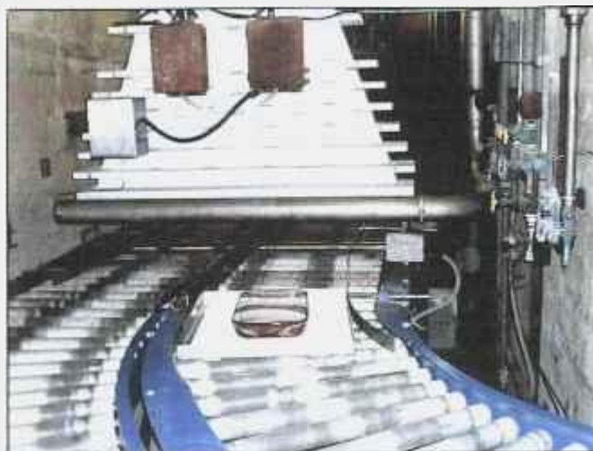
Figura 9. Irradiação das soluções de surfactantes no acelerador de elétrons do IPEN.
