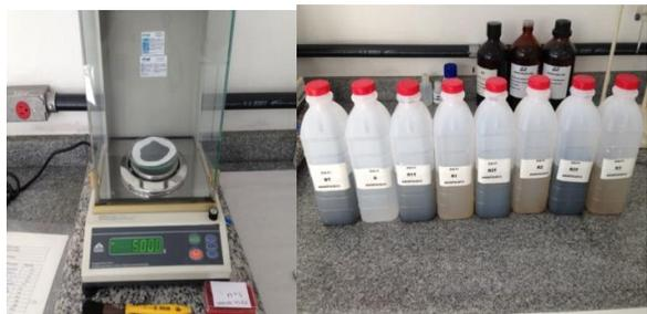
**Figura 1:** Pesagem e adição do adsorvente zeólita de cinza de carvão no efluente do IPEN
