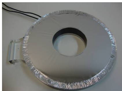
Figura 1 – Câmara de ionização anelar com eletrodo coletor de grafite.
