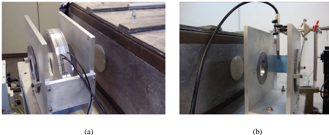
Figura 2 – Posicionamento das câmaras de ionização no feixe de radiação: (a) anelares e de transmissão (na foto é mostrada a câmara de ionização anelar com eletrodo coletor de alumínio) e (b) cilíndrica.
