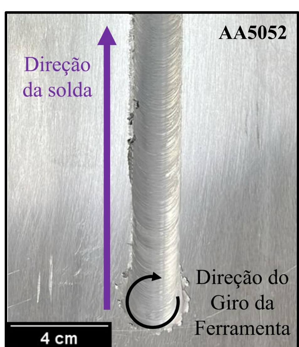
Chapa de AA5052 soldada com DP600 por FSW. O aço está por baixo do AA5052.
