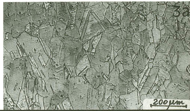
Figura 3a - Micrografia Óptica: Microestrutura da liga Cu-2,2%Ni-0,6%Be solubilizada e conformada a frio (30% red. espessura). Grãos levemente alongados e presença de beriletos.
