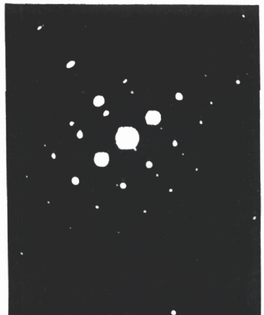
Figura 11: (a) Imagem em campo escuro feito com parte do primeiro anel (100) do padrão de difração eletrônica da amostra apresentada na figura 10. (b) Padrão de difração eletrônica de um núcleo ordenado da amostra da figura 11(a).
