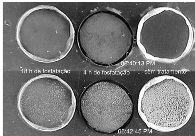
Figura 9-4: Evolução de bolhas na superfície de 3 amostras de ímã NdFeB (fosfatado por 18 h, fosfatado por 4 h e não fosfatado) em solução 0,02mol/L HCl (pH 1,8). As três amostras superiores estão no estado inicial do ensaio e as amostras respectivas abaixo mostram o efeito da corrosão após 2m32s de imersão.
