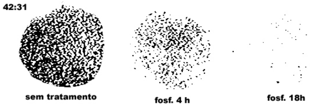
Figura 11-5: Exemplo das imagens fotográficas tratadas por segmentação para avaliação da área total ocupada pela fase escura (recurso eletrônico do programa Quantikov 96). O tempo indicado no canto superior esquerdo corresponde a 1 min e 51 s após imersão das amostras em solução ácida (0,01 mol/L HCl).
