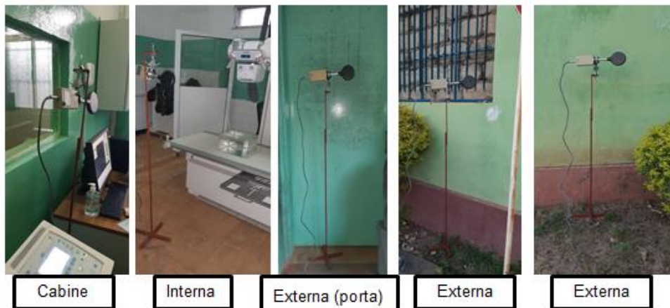
Figura 12 - Imagens da medição, mostrando o posicionamento da câmara de ionização na sala 2 do HNSM
