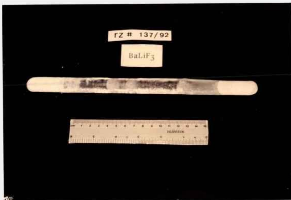
Figura 4.9 Barra policristalina de BaLiF_3 após processo de refino por zona.
