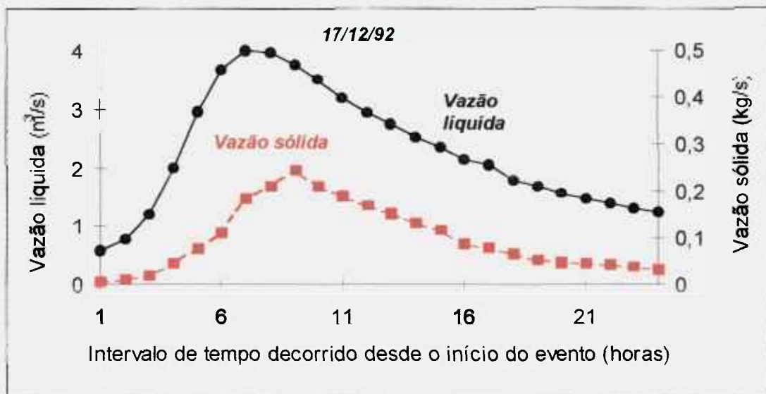
Figura 4.12. Dados de vazão líquida e sólida em função do intervalo de tempo de amostragem.
