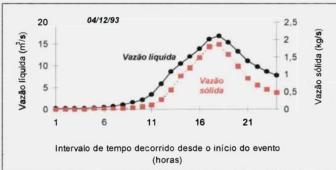
Figura 4.13. Dados de vazão líquida e sólida em função do intervalo de tempo de amostragem.
