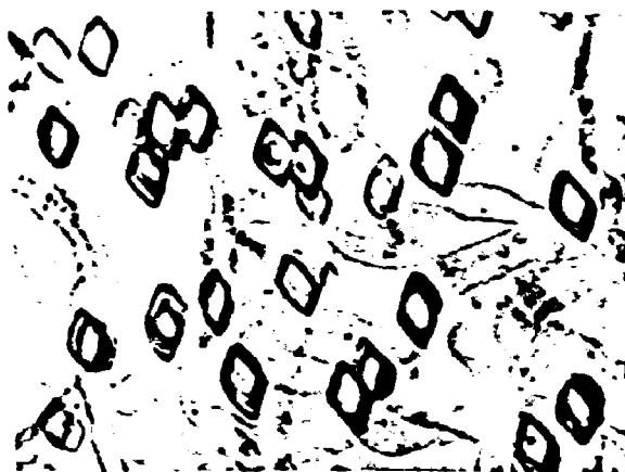
Fig. 5. Traços de fragmentos de fissão na mica
