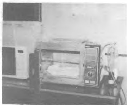
Figura 1 - A esquerda está mostrado o forno transpassado pelo tubo de quartzo, para o controle de atmosfera; a direita apresenta-se o forno com o sistema completo de aquecimento.
