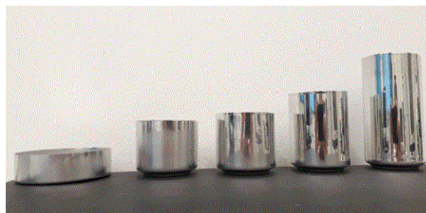
Figura 4-Etapas progressivas de conformação utilizadas na obtenção de corpos de prova para análise de textura
