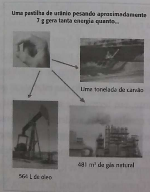
Figura 8.36 – Esquema mostrando comparação de combustíveis.
