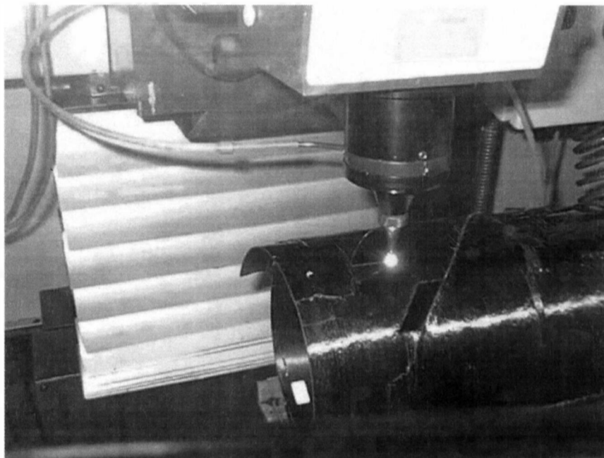
Figura 4.12- Corte a laser para retirada de amostras para análise no MEV.
