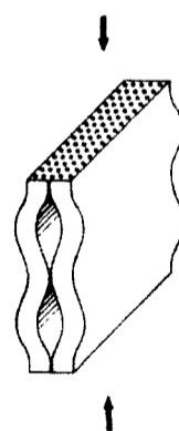
Figura 3.9- Efeito da tração transversal na lâmina devido à carga de compressão longitudinal na direção das fibras [39].
