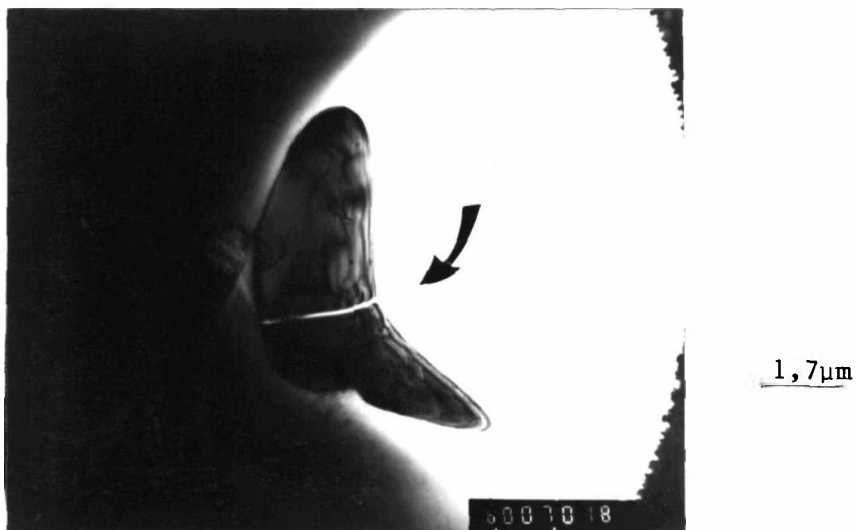
FIGURA 24 - FOTOMICROGRAFIA ELETRÔNICA (MET). AMOSTRA MPD. PRECIPITADOS GROSSEIROS ( \text{M}_{23}\text{C}_6 ). IMAGEM DE CAMPO CLARO. AUMENTO DE 6.000 X.
