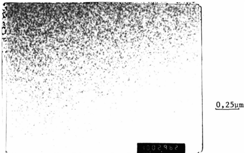
FIGURA 15 - FOTOMICROGRAFIA ELETRÔNICA (MET) DA AMOSTRA MPB MOSTRANDO OS PRECIPITADOS FINOS DE \gamma'' NA MATRIZ. IMAGEM DE CAMPO CLARO. AUMENTO 40.000 X.
