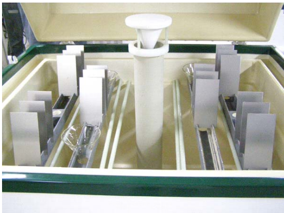
Figura 1. Disposição dos corpos-de-prova na câmara de névoa salina.
