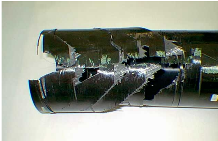
figura 7- aspecto superficial, após colapso, de um cilindro fabricado por superposicionamento de camadas.
