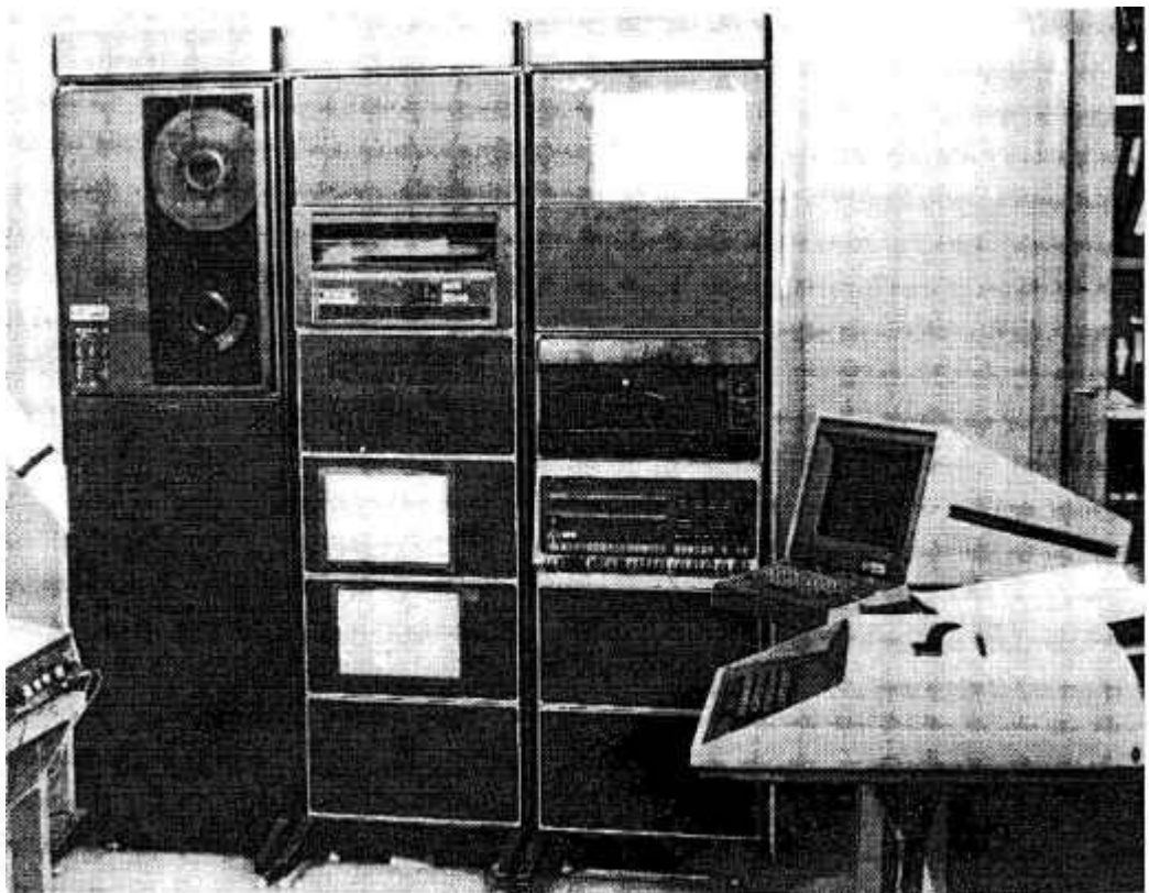
Figura 1 - Foto do minicomputador Digital PDP-11, mostrando da esquerda para a direita; a unidade de fita, um disco removível de 2,2 Mbytes, a leitora/perfuradora de fita de papel, o terminal gráfico Tektronix e o console DECWriter. Vale lembrar que nesta época não havia terminal de vídeo alfanumérico e toda comunicação com o PDP-11 devia ser feita através da DECWriter ou do terminal Tektronix.
