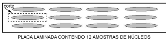
Figura 2 – Esquema de corte das amostras individuais de núcleos U_3O_8 -Al a partir da placa laminada.
