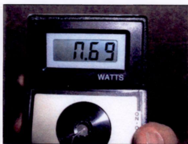
“FIGURA 09a. Medidor de Potência (Power Meter) (Coherent, USA)”.
