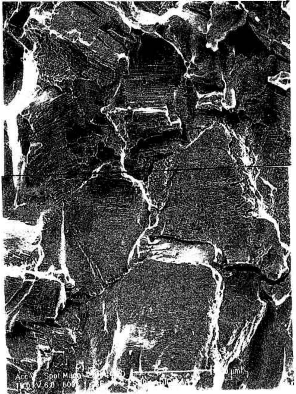
Figura 53. Fratura intergranular e estrias: amostras não jateada
