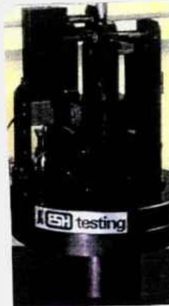
Figura 20. Equipamento portátil de teste de fadiga
