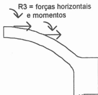
figura 4 - Reações R3 no tampo do VPR
