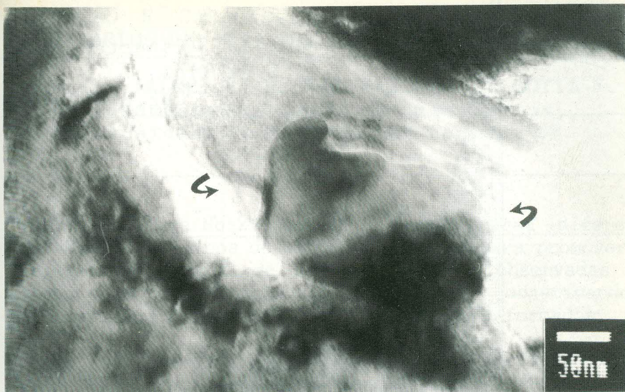
Fig. 1a - Precipitado do tipo "berileto" em liga Cu-2,2%Ni-0,6%Be.
