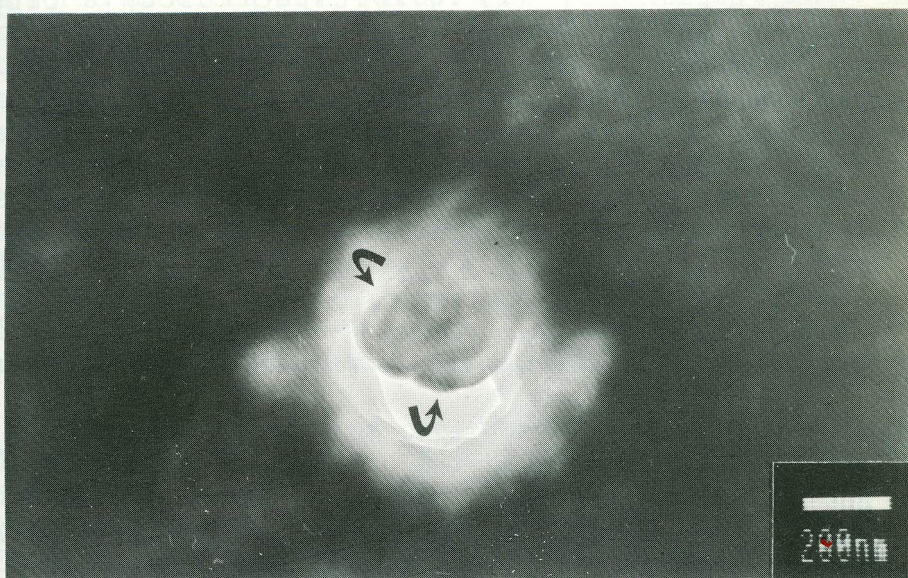
Fig. 1b - Precipitado do tipo "berileto" em liga Cu-2,2%Ni-0,3%Be.
