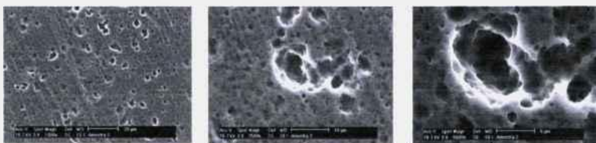
Figura 6.7 – Micrografias obtidas por MEV ( elétrons secundários), da superfície da liga de alumínio, mostrando regiões onde ocorreu à remoção de partículas de segunda fase ricas em ferro pelo ataque em solução de ácido nítrico e fluorídrico.
