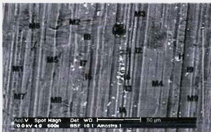
Figura 6.5 – Micrografia obtida por MEV da superfície da liga AA5052H32 como recebida. Os pontos indicados na micrografia foram analisados por espectrometria de energia dispersiva e os resultados são apresentados na Tabela 6.3.
