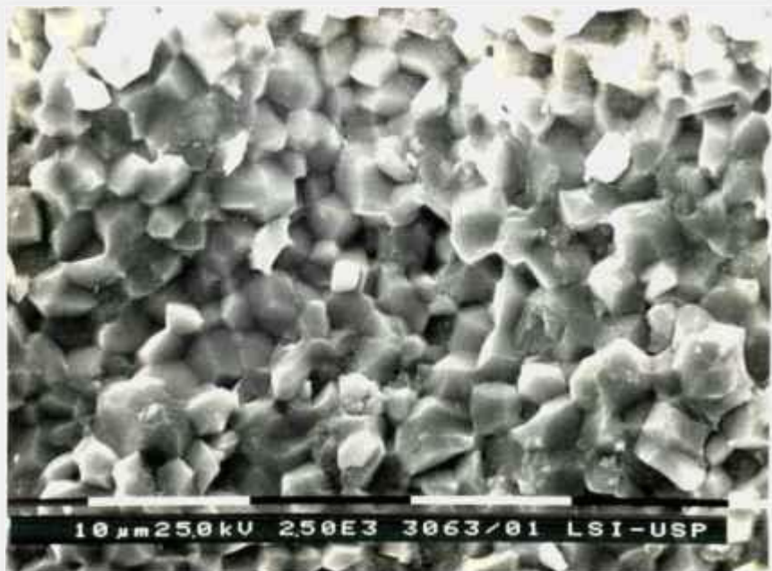
FIGURA 4.21: Micrografia de Varredura da Superfície de Fratura da Amostra Contendo 3,16% de Magnésia.
