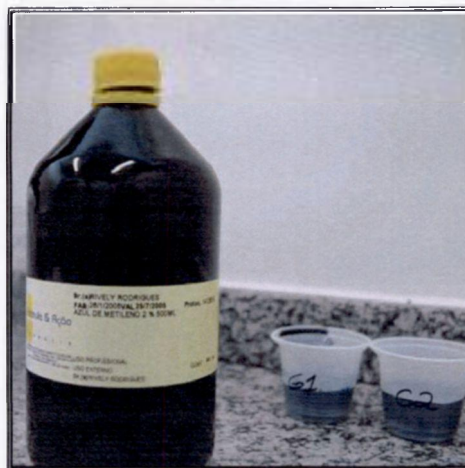
Figura 4.10 - Imersão no corante azul de metileno
