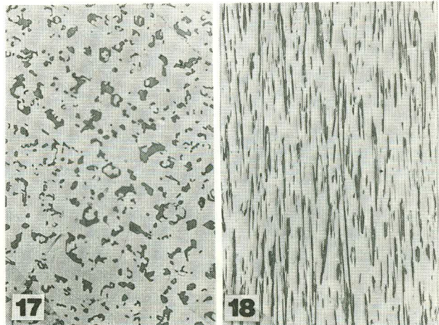
Fig. 17 – Estrutura do eutético (Al)- \text{ThAl}_3 . Seção transversal à direção de crescimento. Solidificação unidirecional. v = 4 mm/h. Liga Al-20,5% Th. Ataque: HF (1%). Aumento: 280 X.
