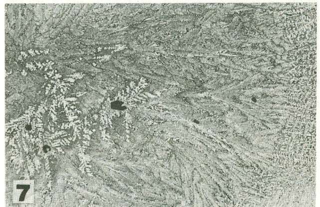
Fig. 7 - Microestrutura da liga Al-26,6% Th hipereutética, mostrando dendritas de alumínio, eutético e partículas de \text{ThAl}_3 . Nota-se que o \text{ThAl}_3 é envolvido por dendritas de alumínio. Ataque: HF (1%). Aumento: 100 X.
