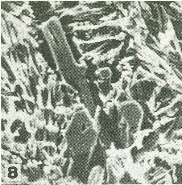
Fig. 8 — Morfologia da fase \text{ThAl}_3 proeutética, em lingote de solidificação convencional. Micrografia eletrônica de varredura. Ataque seletivo: \text{NaOH} (5%). Aumento: 700 X.
