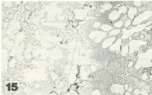
Fig. 15 – Estrutura obtida no mesmo lingote das figuras 13 e 14. Dendritas de alumínio e eutético interdendrítico com estrutura complexa regular e irregular. Seção transversal à solidificação unidirecional. v = 400 mm/h. Ataque: HF (1%). Aumento: 600 X.
