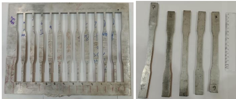
Figura 2: a) Chapa, b) corpo de prova obtido após corte através do método de eletroerosão a fio. Fonte: Própria do autor.
