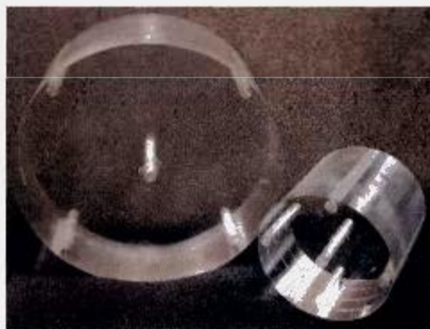
FIGURA 6.8 - Simuladores dosimétricos de acrílico: o menor é o simulador de cabeça e tem diâmetro de 16 cm; o maior é o simulador de abdômen e tem diâmetro de 32 cm. Os simuladores pertencem ao Serviço Técnico de Aplicações Médico-Hospitalares, IEE/USP.
