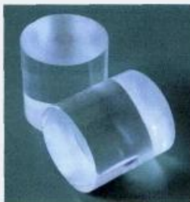
FIGURA 6.7 - Dois filtros de acrílico, com diâmetro de 7,6 cm e espessura de 8 cm, utilizados para simulação de feixes de radiação mais próximos aos feixes atenuados pelos simuladores dosimétricos.
