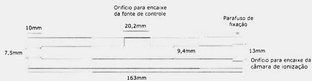
FIGURA 8.2 - Arranjo de Lucite confeccionado para realização do teste de reprodutibilidade.
