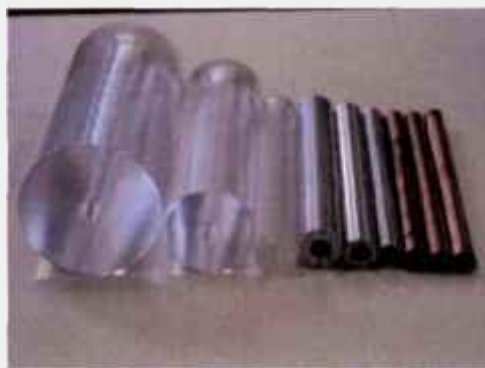
FIGURA 9.1 - Capas absorvedoras confeccionadas para o estudo de um sistema de verificação das CSR em tomógrafos.
