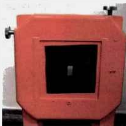
FIGURA 6.3 - Colimador retangular, tipo diafragma, que foi utilizado para irradiação parcial da câmara C9.
