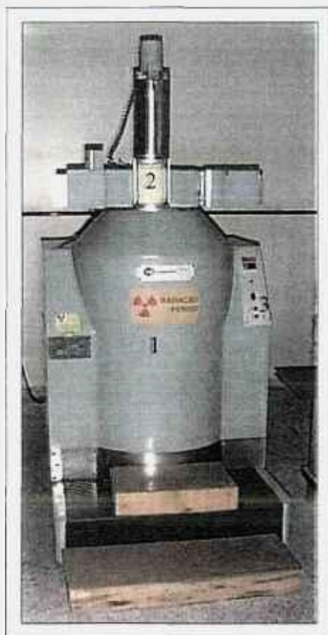
FIGURA 3.5 – Irradiador de cobalto-60 Gammacell-220. (1) câmara secundária com recipiente para amostras; (2) câmara primária (3) Painel de controle.
