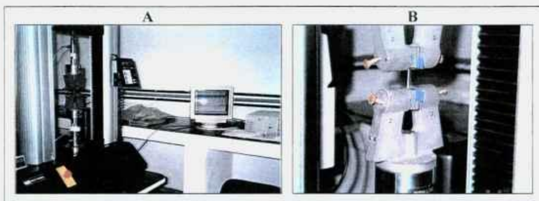
FIGURA 3.4 –Máquina Universal de Ensaios Instron.(A) Aspecto geral , controles e sistema computacional. (B) Garras segurando corpo de prova..
