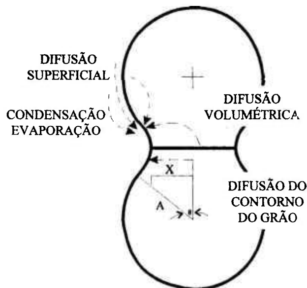
Figura 3 - Mecanismos de transporte de massa durante a sinterização [17] .
