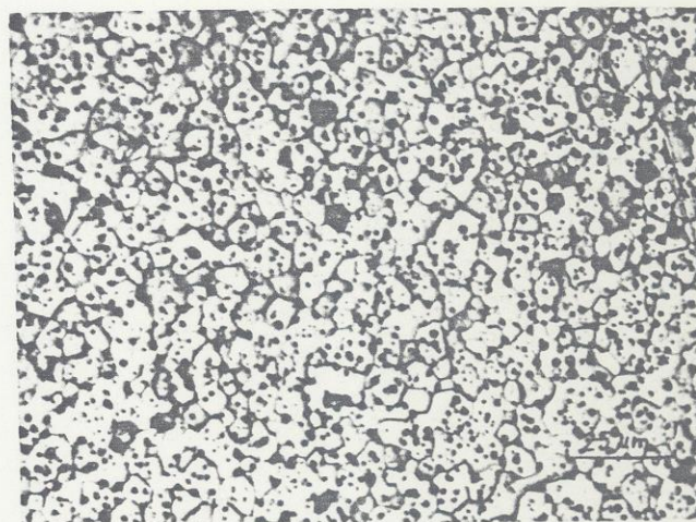
Figura 10b — Micrografia de pastilha constituída de mistura 5, sinterizada a 1700°C por 2 horas.
