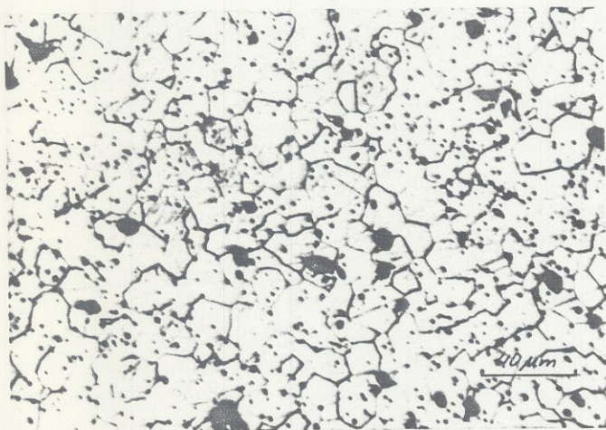
Figura 12a — Micrografia de uma posição central da pastilha constituída de mistura 1, sinterizada a 1500^{\circ}\text{C} por 1 hora.
