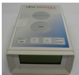
Figura 2. Medidor não-invasivo PTW, modelo Diavolt Universal All-in-one QC Meter
