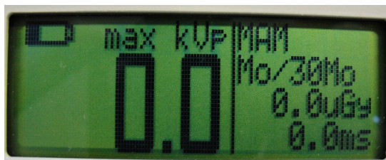
Figura 7. Display do Diavolt quando é selecionada a opção Mo/30Mo
