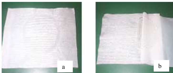
Figura 2. a) Curativo preparado com fita adesivada de NW tipo 1; b) curativo com liner levantado verificando-se reticulação não adequada da membrana de hidrogel.
